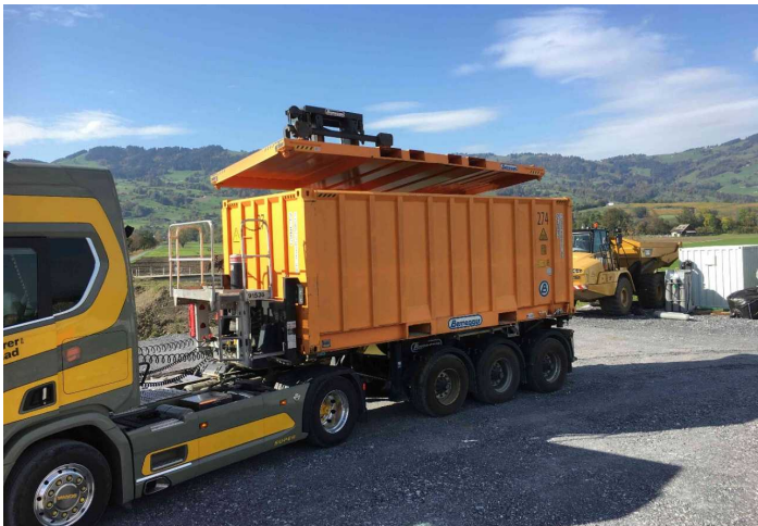
Das belastete Material wird in geschlossenen Mulden abtransportiert.
